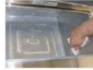
Étape 3 Nettoyez toutes les surfaces intérieures avec un chiffon propre imbibé de solution Kay-5® ou de solution désinfectante à base de chlore. Asséchez-les à l'aide d'un chiffon propre.
