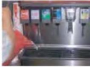
Étape 1 Versez 1,89 litre (1/2 gallon) de la solution Kay-5® ou de la solution désinfectante à base de chlore sur le support à gobelet et l'égouttoir, en laissant la solution s'écouler par le drain.
